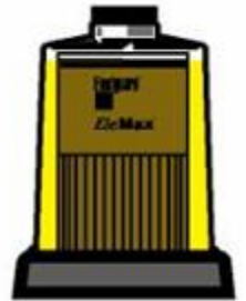
ไส้กรองตัน ถึงเวลาที่ จะต้องเปลี่ยนไส้กรอง
